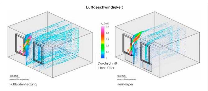
Mit dem I-tec Lüfter von Internorm ist die effektive Luftgeschwindigkeit im unteren Bereich gewährleistet → es treten im Raum keine Zuglufterscheinungen auf bei gleichzeitig hohem Luftaustausch (unabhängig ob Fußbodenheizung oder Heizkörper). Simulation mit I-tec Lüftung in Stufe 1 / Quelle: ITG Dresden
