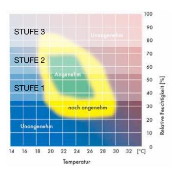
Im Automatikmodus schaltet der Lüfter selbständig über die aus der Abluft ermittelte Feuchte die notwendige Leistungsstufe ein. Bei einer Zulufttemperatur über der Raumtemperatur wird die Automatikfunktion ausgeschaltet.
