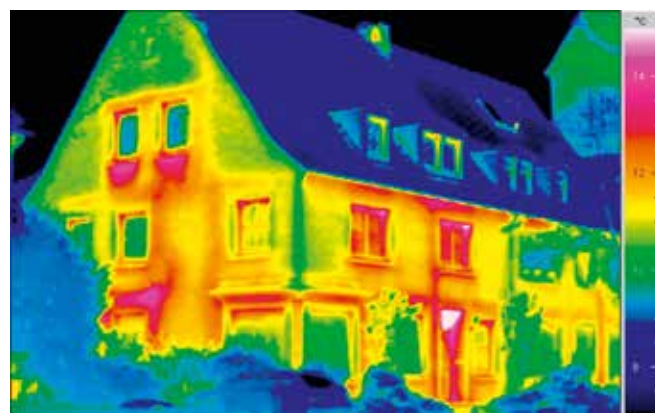
Aufnahmen mit der Wärmebildkamera helfen, Wärmebrücken am Haus zu entdecken. Foto: Verband Privater Bauherren e. V./ Bundesverband Deutscher Baustoff-Fachhandel e. V.
