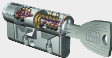
Der **Hochsicherheitszylinder** mit dreidimensionaler, patentierter Abtast- und Aufbohrschutz sowie Zieh- und Abreiß-Sicherung. Die große, spezielle Schlüsselform ermöglicht leichtes Sperrern und verhindert Verbiegen und Abbrechen des Schlüssels. Er ist beidseitig sperrbar. Der symmetrische Wendschlüssel kann sehr leicht in den Zylinder eingeführt werden.
