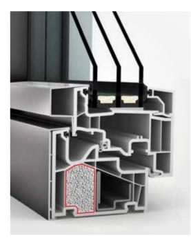
I-tec Insulation: Das Isoliergranulat füllt die Hohlkammern umlaufend gleichmäßig aus, wodurch der Wärmeschutz verbessert und die Energiekosten gesenkt werden. Ein Plus für unser Klima und Ihre Geldbörse.
